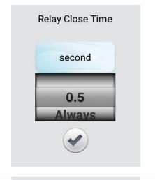
Relay Close Time — Время задержки работы реле GSM модуля в замкнутом состоянии (NC). По умолчанию время задержки 0,5 секунды.
