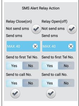
Relay ON/OFF SMS Alert - Настройка получения СМС сообщений при включении (замыкании) и отключении (размыкании) реле GSM модуля, а также изменения текста СМС сообщений. По умолчанию СМС сообщения отправляются как при включении, так и при отключении реле GSM модуля, как администратору, так и пользователю.
