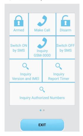
**Armed** — Активация режима тревоги. При замыкании подключенного датчика, будут приходить СМС сообщения и выполняться телефонные звонки первым шести пользователям, внесенным в список.
