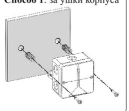
Рисунок 1 – Крепление корпуса Radio 8615 IP65 способом 1
