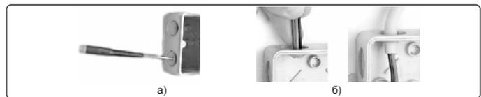
Рисунок 4 – Ввод кабеля в корпус Radio 8615 IP65
